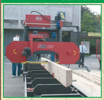
SCAD 800 es una sierra de cinta para uso profesional. Presenta un marco sólido estable y una conducción exacta de la cinta. La tensión de la cinta se realiza de forma hidráulica con indicación de la tensión. La cinta se enfría con agua.
