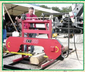
Es apropiada para manufactureros, constructores o carpinteros, para los cuales no es fundamental la potencia sino la calidad de las piezas cortadas y la posibilidad de trabajar la madera en rollo directamente en la zona de explotación o en la zona de su consumo. El ajuste de la altura del corte se realiza de forma manual. El desplazamiento de la sierra en dirección al corte se
