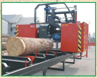
Esta sierra basculante de disco UP700 – es una máquina de igual construcción pero mayor que la sierra UH500 – sin embargo, está destinada para la elaboración de troncos de mayores diámetros. Esta máquina presenta un principio de trabajo y ventajas similares a la sierra UH500. El grado de automatización, la forma de corte y el control de la marcha
