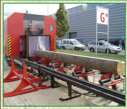
Esta sierra con dos discos perpendiculares entre sí facilita el corte en ambas direcciones, aumentando considerablemente la capacidad de corte de la misma.
