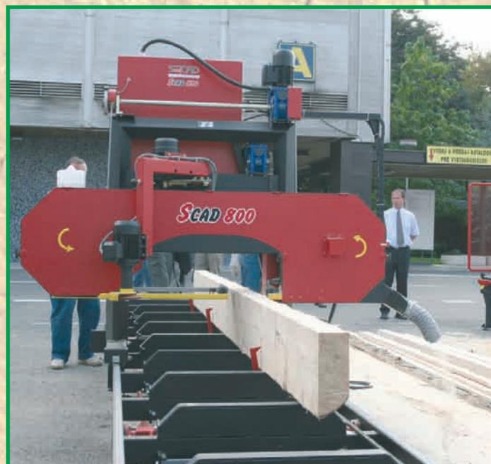
SCAD 800 ist die Bandsäge für professionelle Nutzung. Sie hat einen massiven stabilen Rahmen. Die Bänderinspannung ist hydraulisch mit der Einspannanzeige. Das Band wird mit Wasser gekühlt. Die Einstellung der Schnitthöhe (Brettdicke) ist elektronisch gesteuert. Das Standardmaschinenelement ist der Vorschnitt. Die Standardeinspannung des Stammes ist manuell. Es ist möglich die Säge auch in der Ausführung mit der hydraulischen Stammmanipulation zu bestellen.
