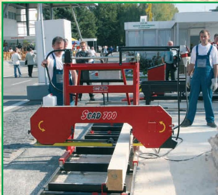
Sie ist passend für die Handwerker, Bauschaffender oder Tischler, für die nicht die Leistung entscheidend ist, sondern Qualität der Schnittproduktion und die Möglichkeit, das Rundholz auf dem Gewinnungsort oder auf dem Schnittholzverbrauchsort zu bearbeiten. Die Einstellung der Schnitthöhe ist manuell. Der Sägevorschub in den Schnitt ist manuell. Die Säge kann mit einem Elektromotor oder Benzinmotorgeliefert werden.
