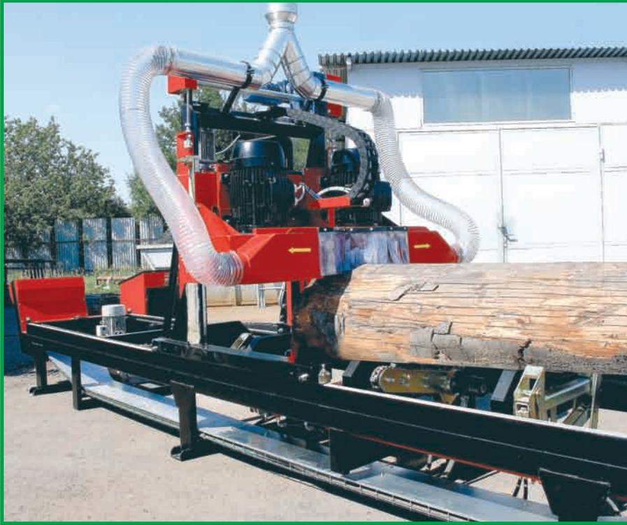
Die Maschine ist ideal für die Produktion des Bauschnittholzes. Zwei horizontale Sägeblätter ermöglichen besäumtes und unbesäumtes Schnittholz zu produzieren.
