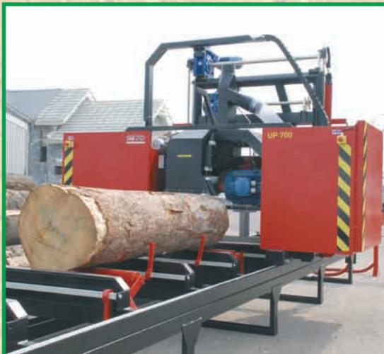
Die Winkelkippsäge UP700 – die Maschine mit der ähnlichen Konstruktion wie die kleinere Säge UH500 – ist aber für die Bearbeitung der Stämme von größeren Ausmassen bestimmt. Das Arbeitsprinzip und Maschinenvorteile sind gleich wie bei der Säge UH500.
