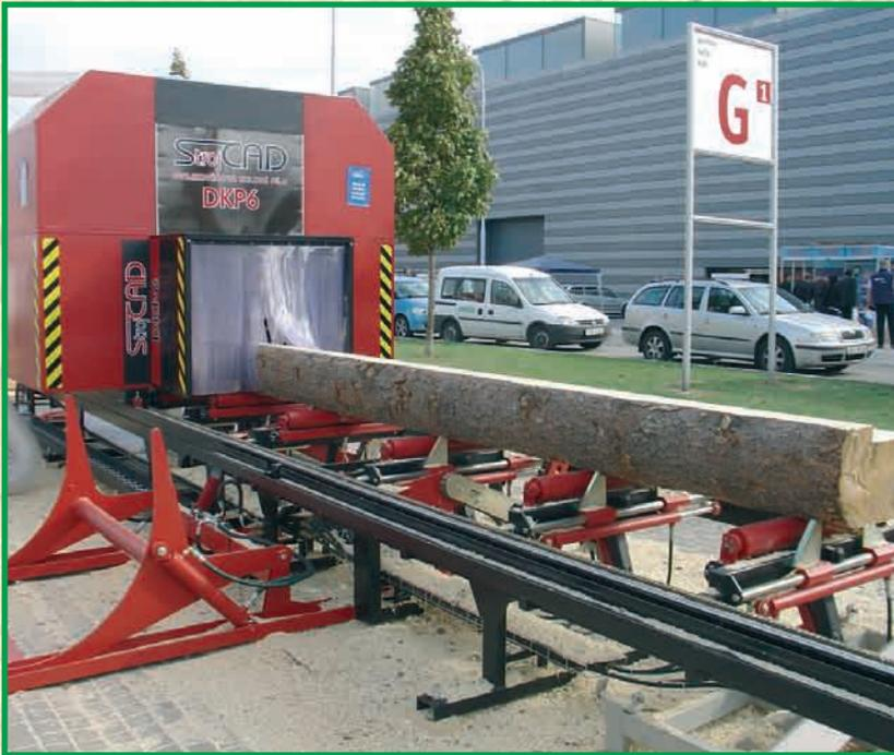
Die Säge mit zwei vertikalen Sägeblättern ermöglicht in beide Richtungen zu schneiden und so ganz markant die Schnittkapazität der Säge zu erhöhen.
